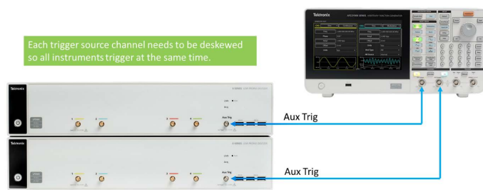
Синхронизация каналов нескольких приборов за 200 пс с использованием вспомогательного входа сигнала запуска и ручной компенсации сдвига
