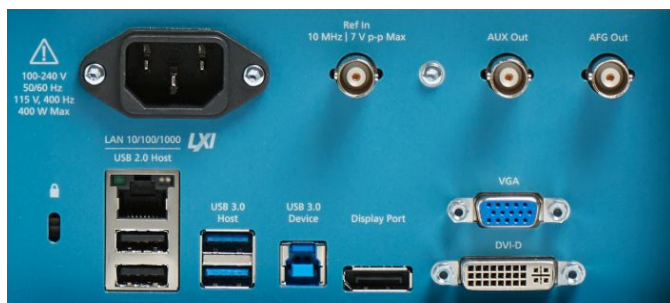
Имеющиеся входы и выходы позволяют подключить осциллограф к любому контрольно-измерительному оборудованию.
