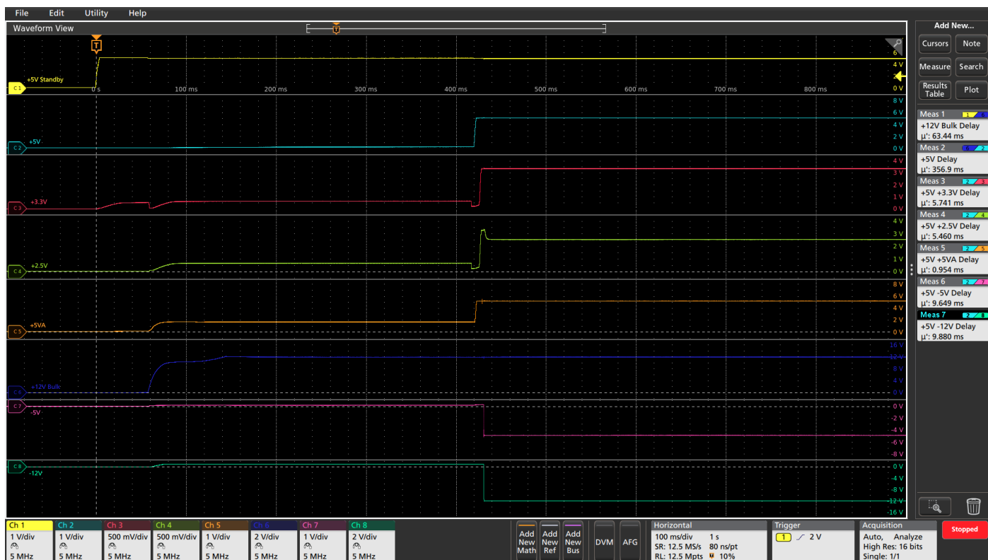
Использование автоматических измерений позволяет получить характеристики источника электропитания.
