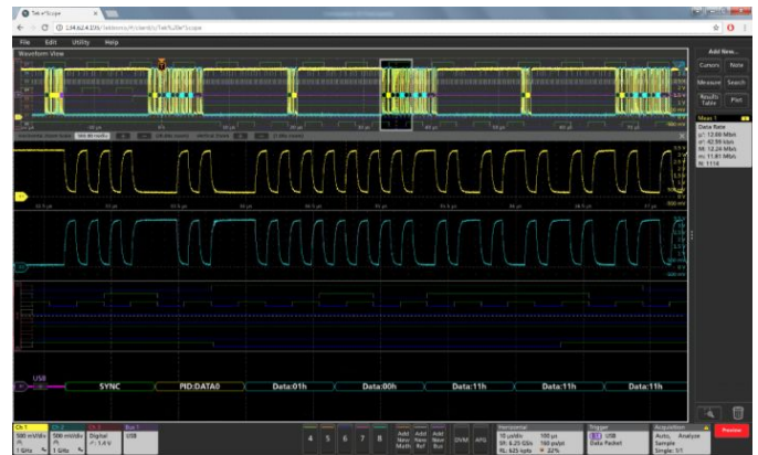
Средства e*Score обеспечивают дистанционное отображение экрана и управление прибором с помощью обычных веб-браузеров.
