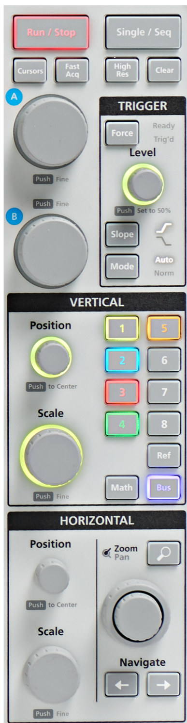
Передняя панель с интуитивно понятными органами управления основными функциями оставляет достаточно места для дисплея высокого разрешения с диагональю 15,6 дюймов.
