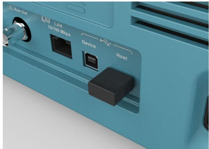
АдAPTERы Wi-Fi, конфигурируемые с помощью встроенного меню, поддерживают непрерывную беспроводную связь
