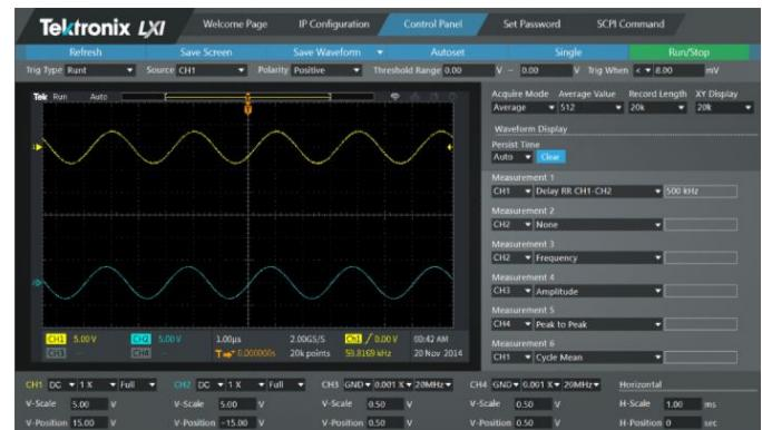
Изображение экрана осциллографа и органов управления передается по локальной сети на экран удаленного компьютера
