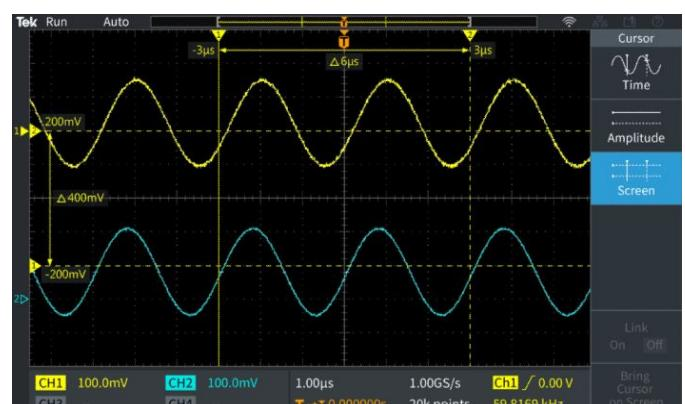
Данные курсоров отображаются непосредственно на осциллограмме. С помощью курсоров измеряют время и амплитуду.
